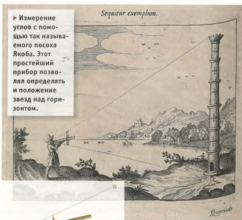
Принцип действия посоха Якоба.
