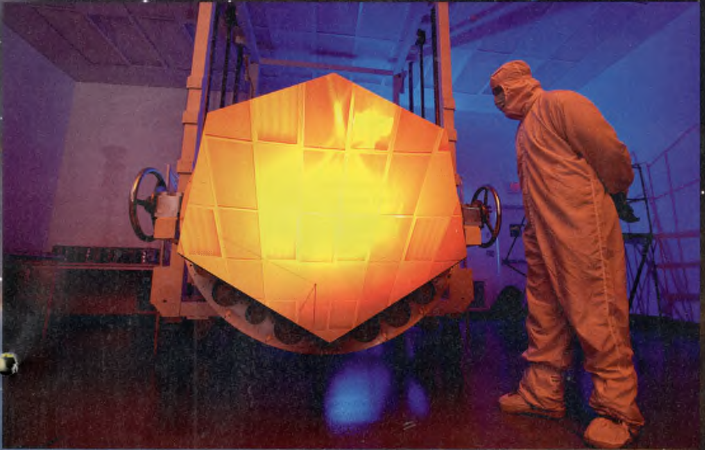
Сегмент зеркала телескопа «Джеймс Уэбб», покрытый золотом.
