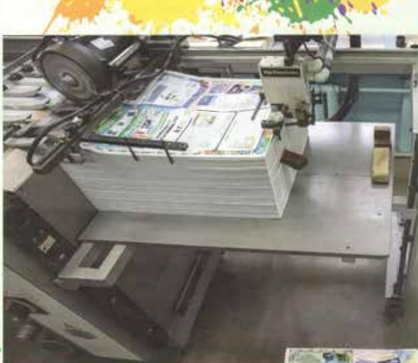
Уфф... Дело движется к финишу. Вот на отдельной машине разрезали и свернули обложки.
