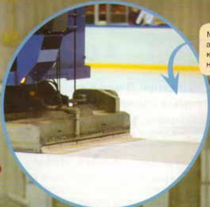
Машина заливает арену горячей водой, которая образует новый слой льда
