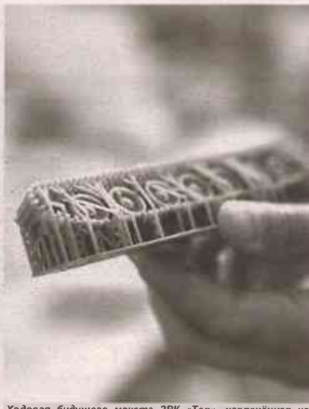
Ходовая будущего макета ЗРК «Тор», извлечённая из 3D-принтера.
